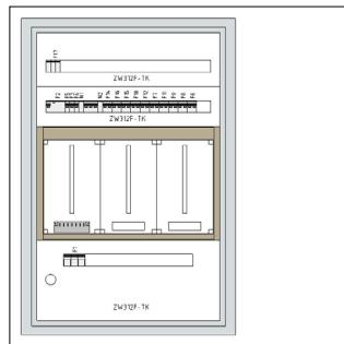
**UP-Zählerverteiler KNT., 3ZPL, bestückt u. verdrahtet, 1093x711x253mm Nischenmaß**
