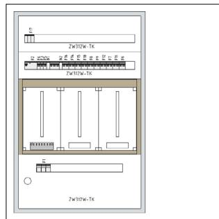
**AP-Zählerverteiler Ktn, 3ZPL, bestückt und verdrahtet, 11763x747x250mm Außenmaß**
